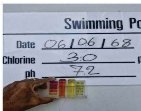
ภาพที่ 3.5.3-1 การตรวจวัด pH และ Cl_2 สระว่ายน้ำ
